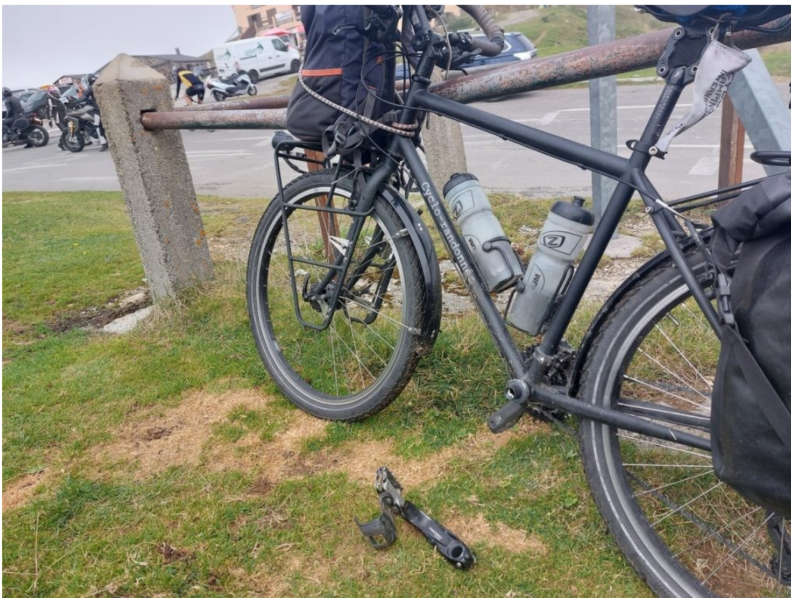
La manivelle gauche détachée de son axe, au sommet de l'Aubisque.
