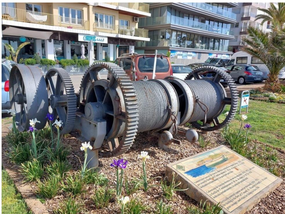
*Cabestan pour remonter la flottille de 17 embarcations de 8 à 10 mètres de long, opérationnel de 1934 à 1975.*
